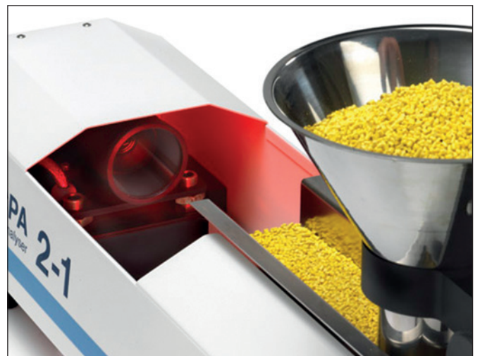
HAYER CPA 2-1 bei der Vermessung von Kunststoffgranulat
