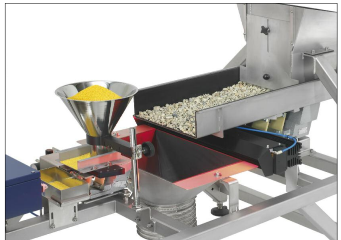
HAVER CPA 4-2 bei der Kornmessung unterschiedlicher Materialien in zwei Messbereichen
